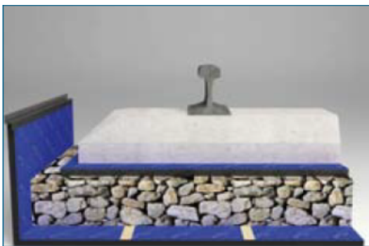
Figuur 1 Trillingsreductie met isolatiematten
